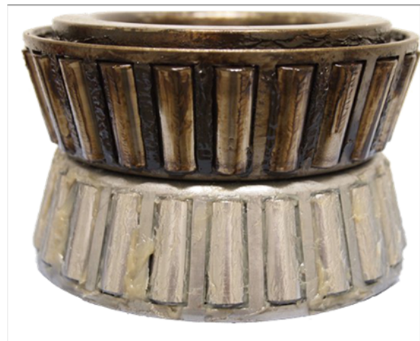
Abb. 2: Geschädigtes Lager durch Verkokung des Schmierfetts (oben) und neues fettgeschmiertes Lager (unter Bildhälfte)
